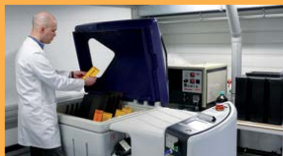
Salt spray test to DIN EN ISO 9227
